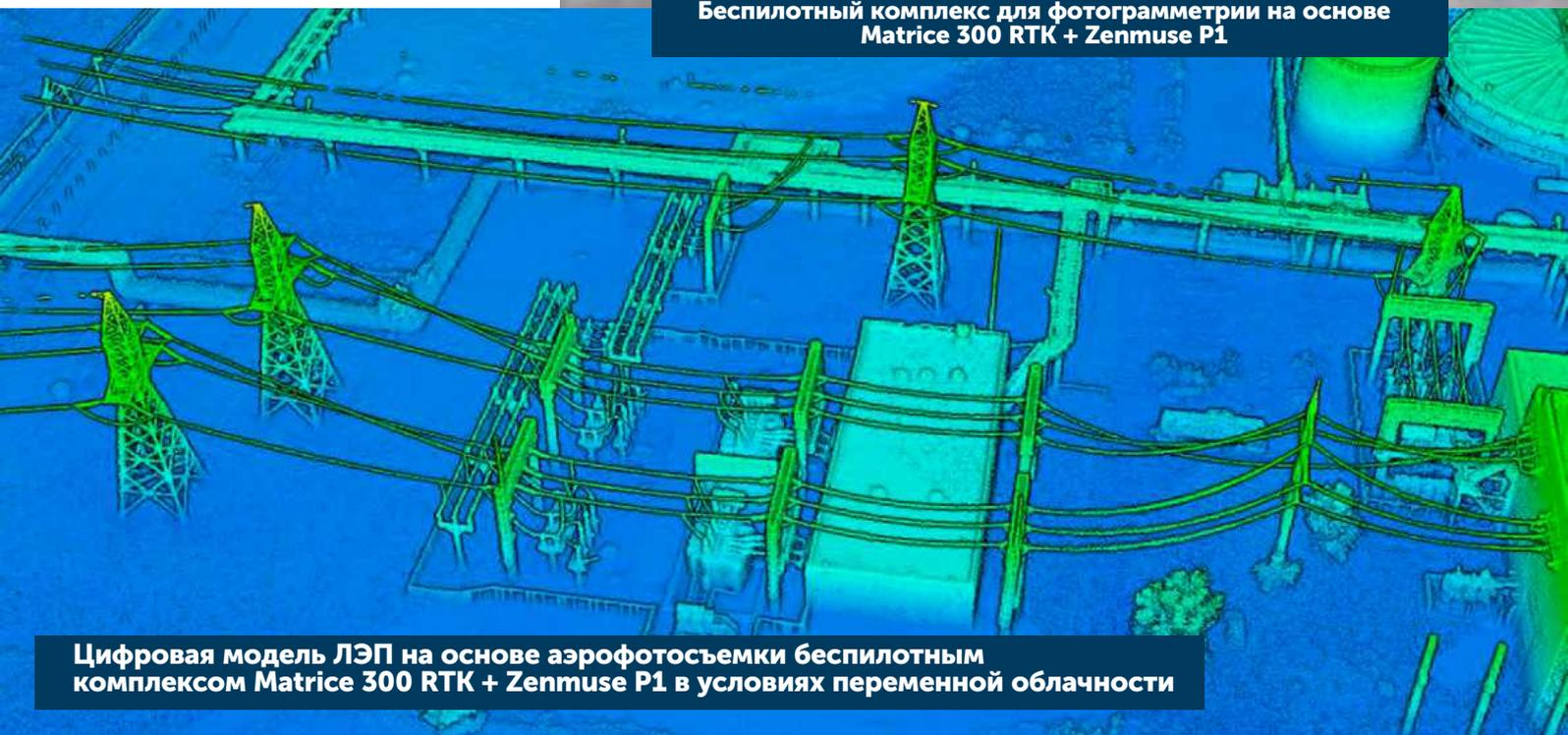
Цифровая модель ЛЭП на основе аэрофотосъемки беспилотным комплексом Matrice 300 RTK + Zenmuse P1 в условиях переменной облачности
