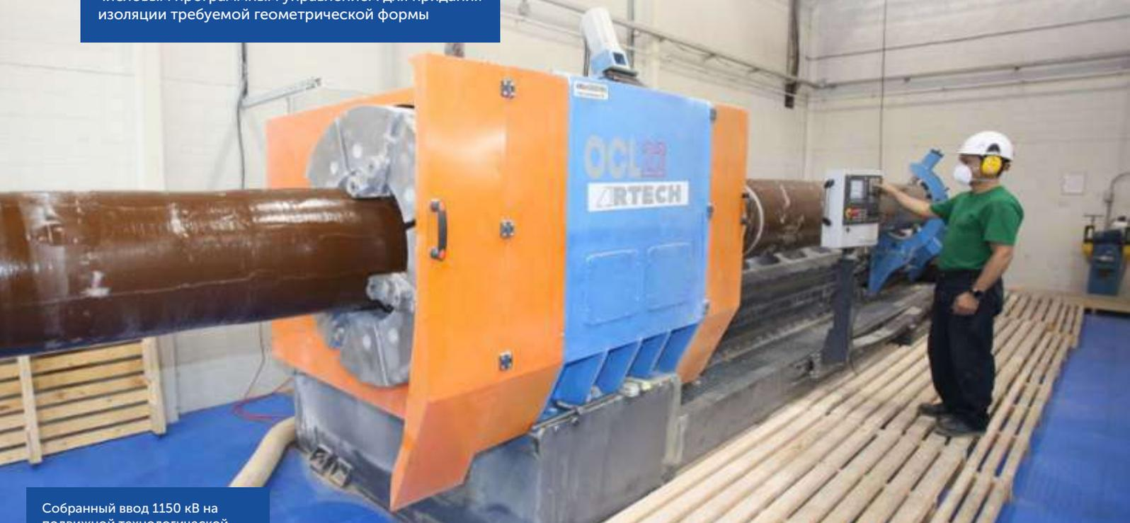
Собранный ввод 1150 кВ на подвижной технологической стойке для перемещения в испытательный центр
