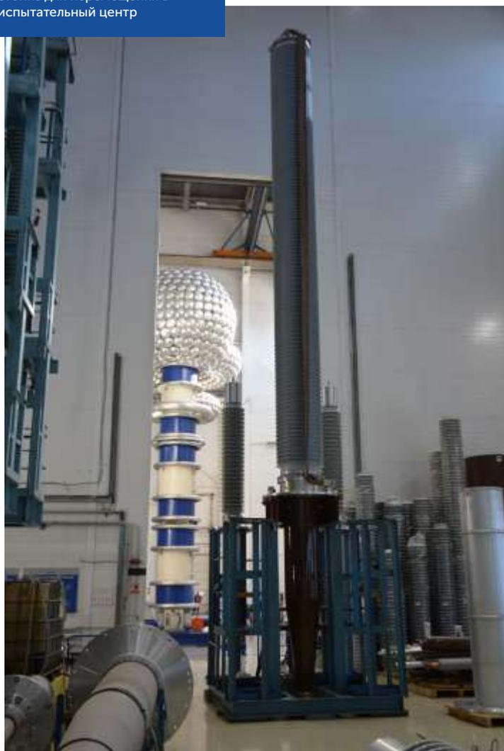
Внешняя изоляция ввода — комбинированного типа, представляющая собой стеклооксидный цилиндр с отлитым непосредственно на его поверхности полимерным оребрением. Полость между цилиндром и внутренней RIP-изоляцией заполнена компрессионным электроизоляционным гелем, специально разработанным для высоковольтных вводов.
