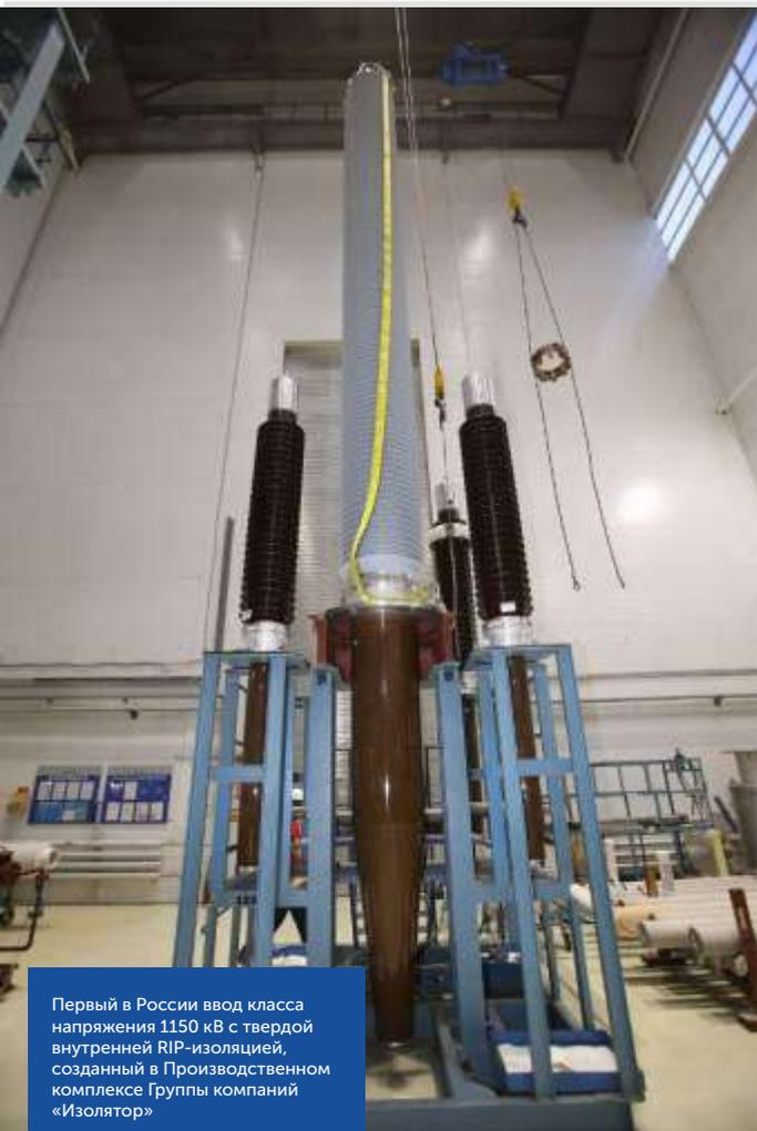
Первый в России ввод класса напряжения 1150 кВ с твердой внутренней RIP-изоляцией, созданный в Производственном комплексе Группы компаний «Изолятор»
