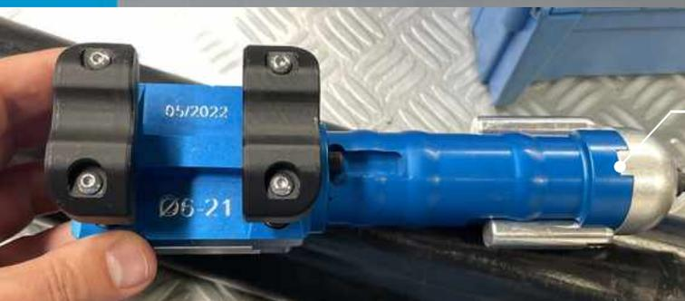
Инструмент Alroc J1R1 используется для снятия оболочки широкого диапазона низковольтных и промышленных воздушных кабелей диаметром от 6 мм до 21 мм. В инструменте предусмотрена установка сменной кассеты в т-слот с различными вариантами настройки глубины и углов реза.
